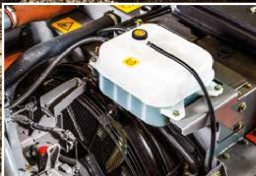
De expansietank voorkomt oververhitting van motoronderdelen.
